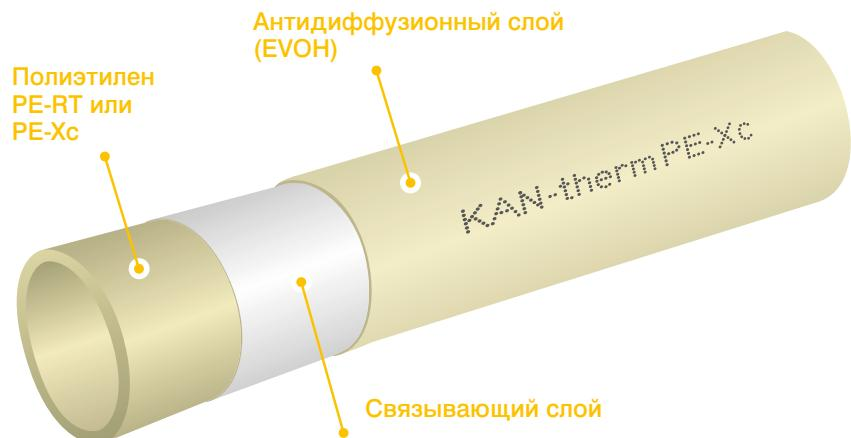
Рис. 48. Конструкция многослойных труб KAN-therm
